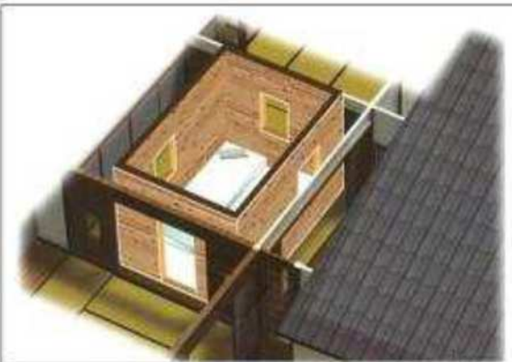
家の内部に耐震シェルターを設置
