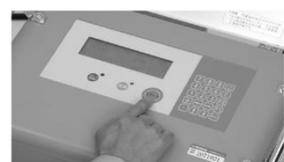
(8) 融着後の検査は、ソケットの融着確認インジケータが適正融着完了を示しているかその都度確認すること。
