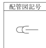
(2) メカニカル継手による標準配管
