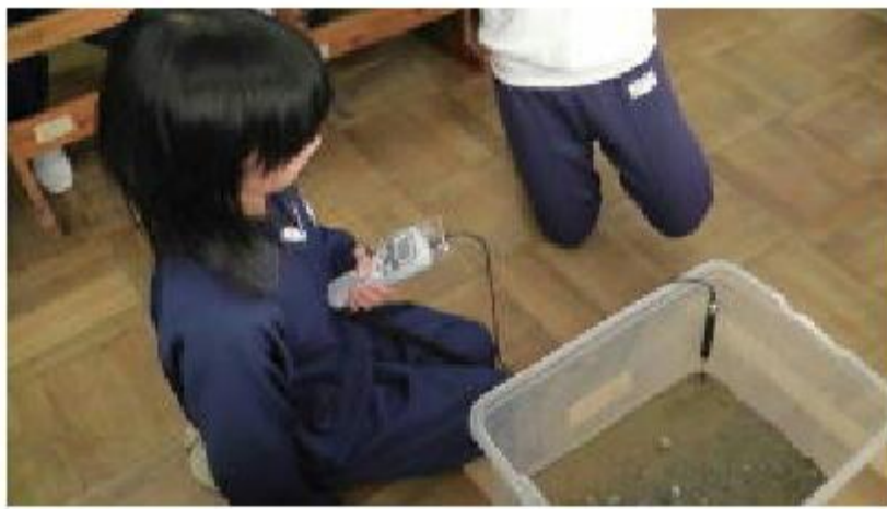
〈地層下部にある湧水の温度を測定する様子〉
