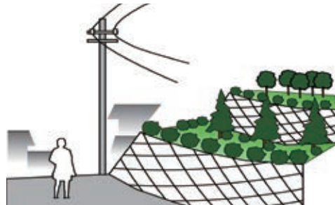
擁壁の小段に植栽を設ける工夫
