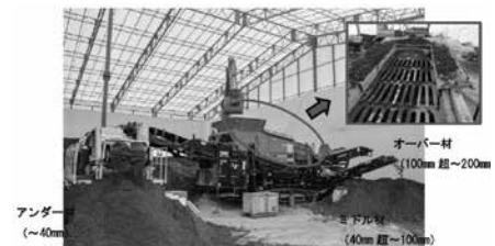
図2.2.13 振動スクリーンによる選別
