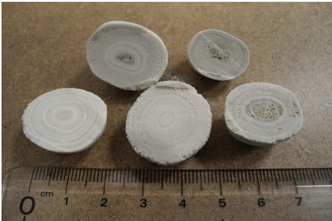
写真 2-13 現在生成中の球状石灰石の断面
