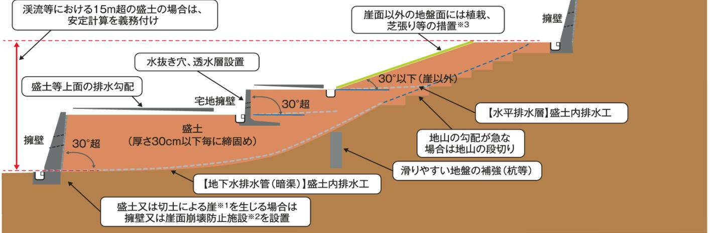
※1「崖」とは、地表面が水平面に対し30°を超える角度をなす土地で、硬岩盤（風化の著しいものを除く）以外のものをいいます。 ※2 住宅等の建築物を建築する地盤には崖面崩壊防止施設（鋼製枠工等）は設置できません。 ※3 道路の路面の部分その他の植栽、芝張り等の措置の必要がないことが明らかな地盤面を除きます。
