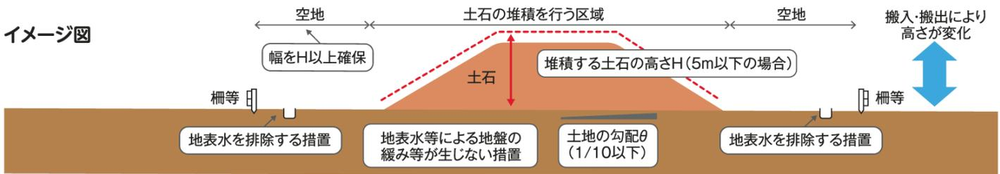
※堆積する土石の高さが5m超の場合、当該高さの2倍を超える幅の空地が必要です。 ※上記は技術的基準を満たす堆積方法の一例であり、施設を設置すること等により空地の確保が不要となる場合もあります。
